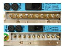
Dietro la protezione in plastica è accessibile il collegamento di terra. Togliendo la piastrina anteriore, è possibile separare la terra delle quattro prese di uscita da quella della rete di alimentazione.
