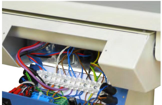
I morsetti per la scelta delle tensioni sono facilmente raggiungibili all'interno del pannello comandi. A questi andranno collegati i cavi provenienti dai lati del piano.
